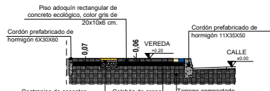
CORTE A-A ADOQUÍN SOBRE COLCHÓN DE ARENA
