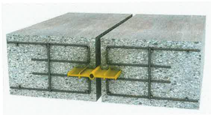
Figura 29 Juntas en Pisos de Azoteas.
