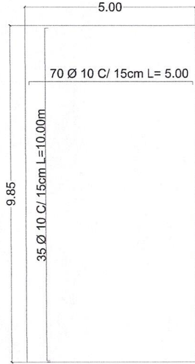
DETALLE DE LA LOSA DE APROXIMACION
