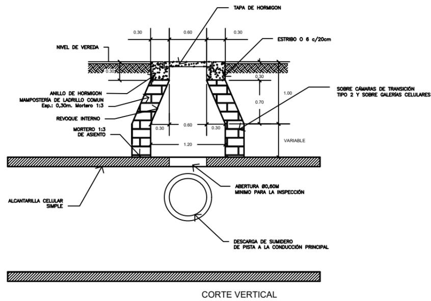
Observación: de acuerdo a la cota de descarga del tubo del sumidero, la conexión se puede realizar en la pared de la alcantarilla celular, o en la pared del registro Tipo E. Los registros de Inspección Tipo E se construirán en las alcantarillas celulares y en las Cámaras Colectoras Tipo 2. En el caso que el Registro Tipo E quede en cozada, la tapa será de Hª.
